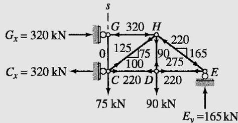
(d) Substructure with Symmetric Boundary Conditions
