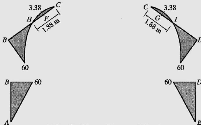
(g) Bending Moment Diagrams ( $\text{kN} \cdot \text{m}$ )
