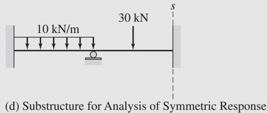
(d) Substructure for Analysis of Symmetric Response
